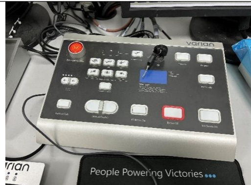
操作室内钥匙开关、急停开关
